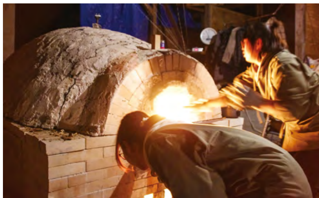
穴窯とは、山の斜面を利用して作った窯で、薪を燃やして作品を焼きます。今から1300年以上前、奈良時代や平安時代に行われていた焼成方法とほぼ同じです。
