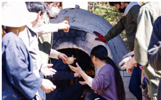
陶芸専攻の学生は年に1度、この穴窯で実習。4日間交代しながら高温を保ち、焼成しています。
